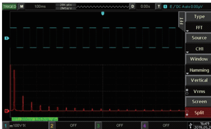
Rys. 5-1 Spektrum częstotliwości FFT
