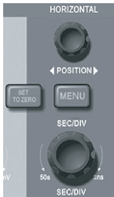
Rys. 2-11 Blok systemu nastaw odchylenia poziomego
