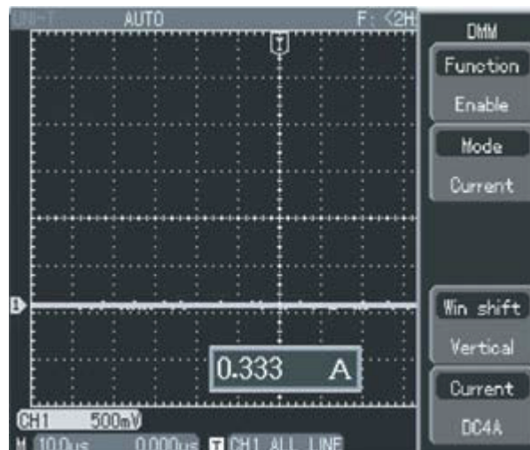
Rys. 3-17 Wybór "dużego" zakresu pomiarowego prądu DC
