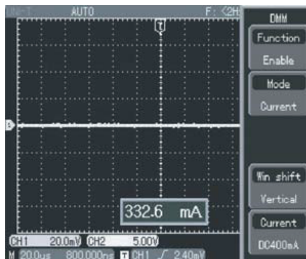
Rys. 3-18 Wybór odpowiedniego zakresu pomiarowego prądu DC
