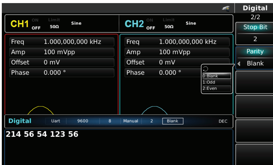
Rys. 4-156 Ustawianie bitu kontrolnego
