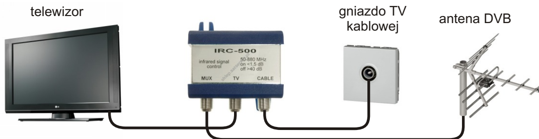
Schemat połączeń gdy przełącznik jest zasilany bezpośrednio z gniazda RF telewizora
